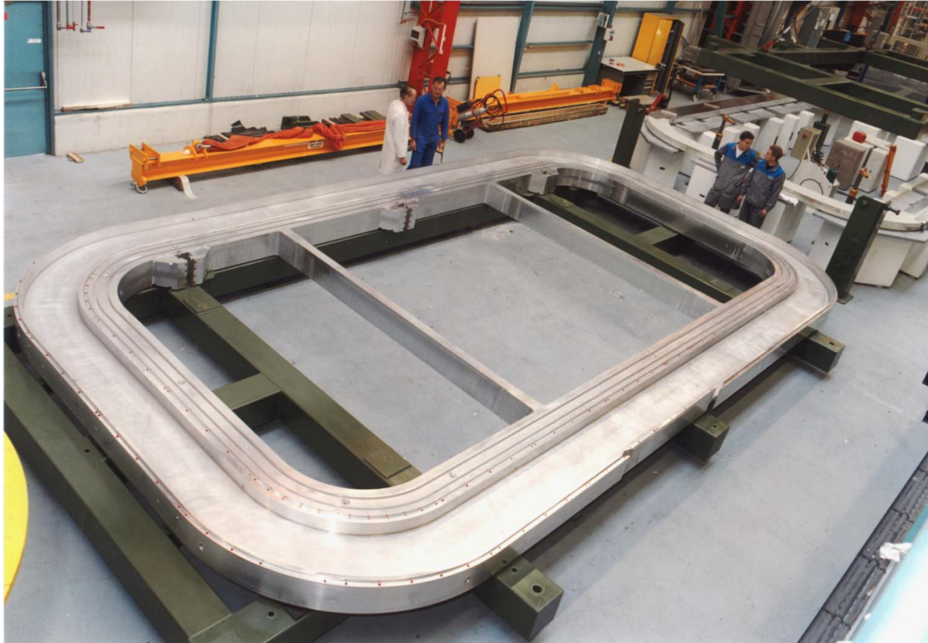
Boîte à bobine en Alliage d' aluminium
